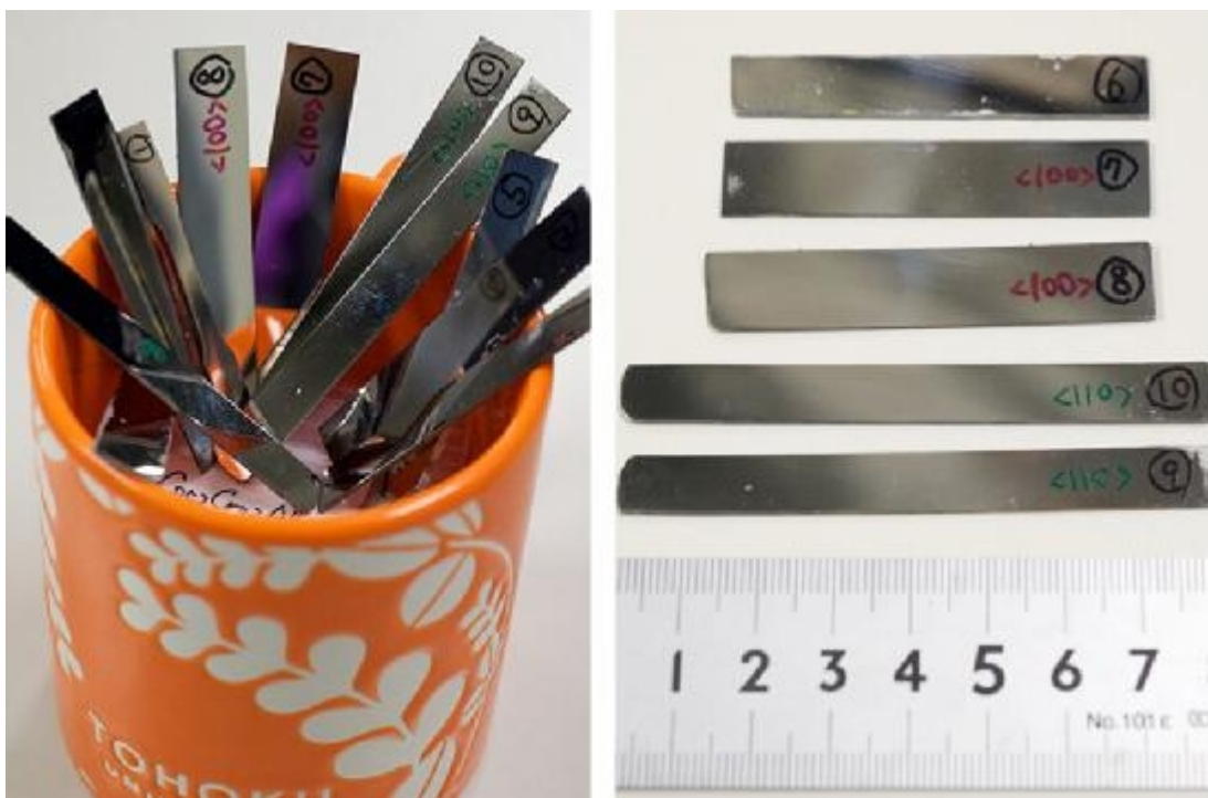
Figura 1. Monocristales de las aleaciones flexibles y tenaces a base de CoCr. Crédito: Universidad de Tohoku.
